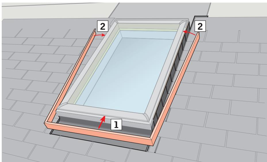
**ENGLISH:** Replace cladding parts as shown.**ESPAÑOL:** Vuelva a colocar los perfiles de recubrimiento como se indica.**FRANÇAIS :** Replacez les pièces du recouvrement, tel qu'illusté.
